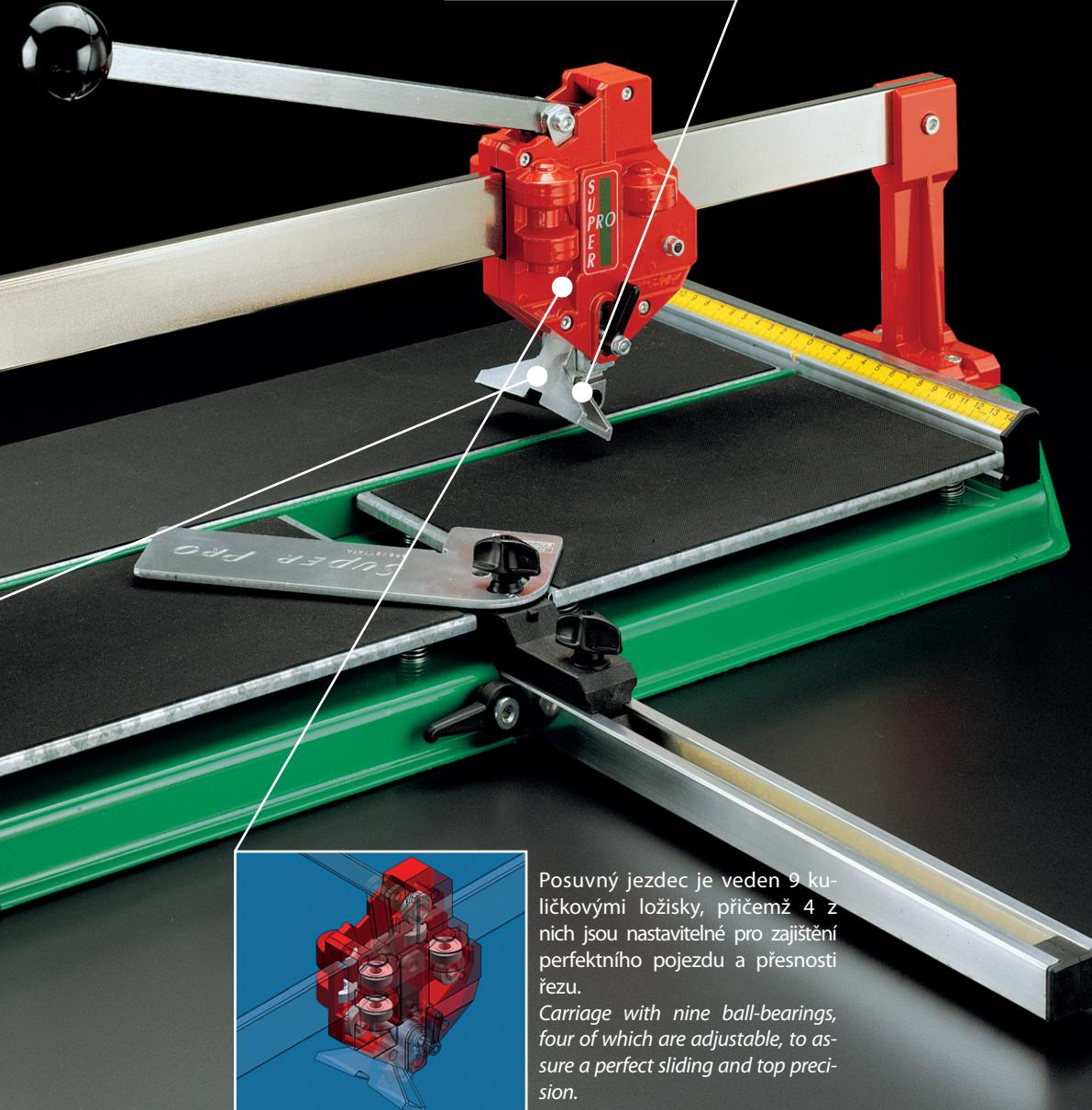
Posuvný jezdec je veden 9 ku- ličkovými ložisky, přičemž 4 z nich jsou nastavitelné pro zajištění perfektního pojedzdu a přesnosti řezu.
